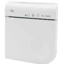
Il sensore wireless di CO<sub>2</sub> rileva il livello di anidride carbonica nell'aria all'interno dell'ambiente in cui è posizionato, inviando le sue misurazioni tramite RF (radiofrequenza) all'unità Zehnder EVO. L'unità varia di conseguenza la sua portata, scegliendo il livello appropriato per garantire la qualità dell'aria interna in base alle informazioni trasmesse del sensore.
