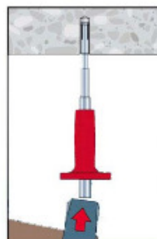
Dübel verspreizen bis Prägung am Dübelrand Expand anchor until marking on flared end Expanser jusqu'au marquage de la cheville
