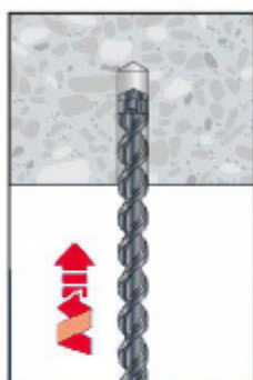
Bohrloch erstellen Drill borehole Percer le trou
