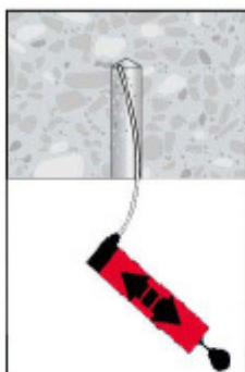
Bohrloch reinigen Clean borehole Nettoyer le trou
