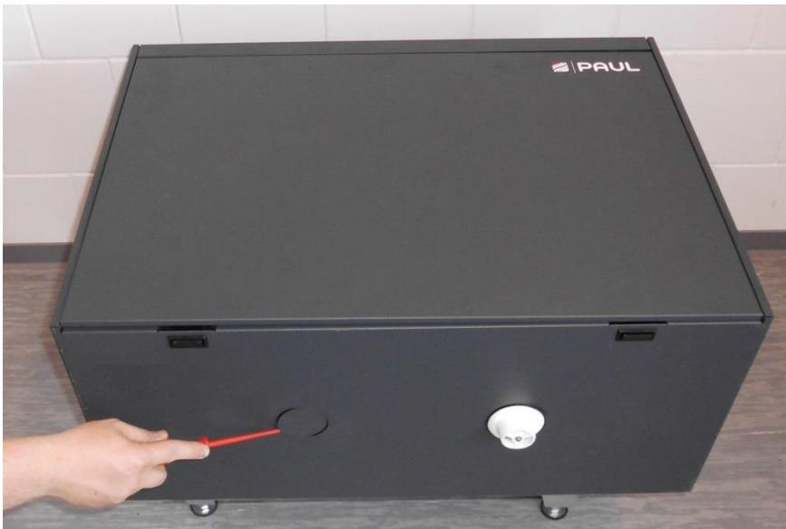
3. Bohren Sie mit einer Bohrkronen 40 mm ein Loch in das EPP-Gehäuse.
