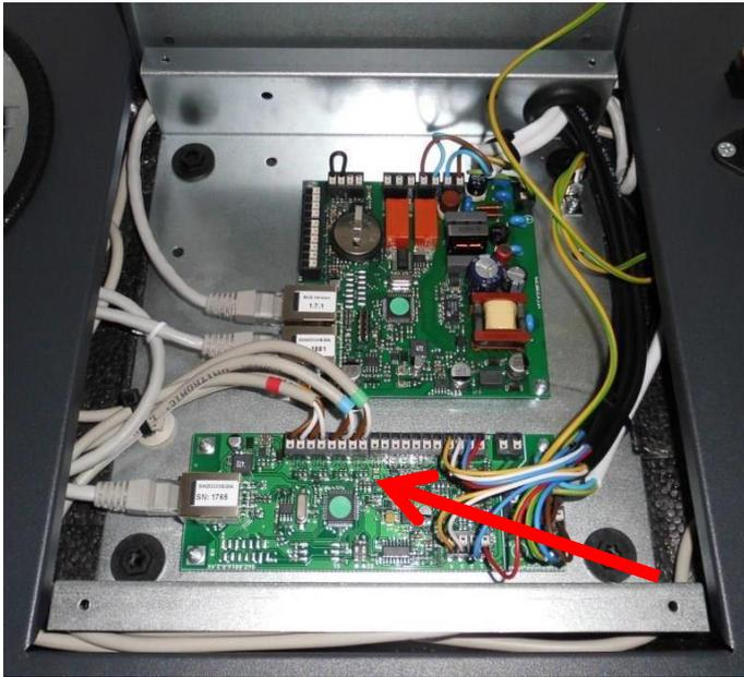
8. Montieren Sie die neue Lüfterslaveplatine im Gerät. Achten Sie darauf, die Kabel laut Schaltplan zu montieren (siehe Anhang).
