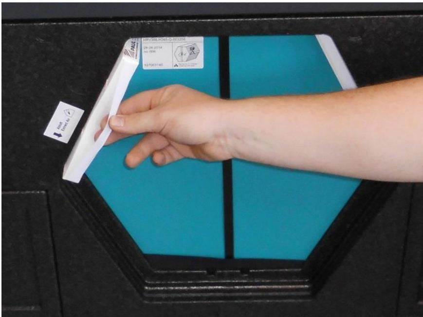
5. Ziehen Sie den Wärmetauscher am Zugband fassend aus EPP-Schaumstoffabdeckung.
