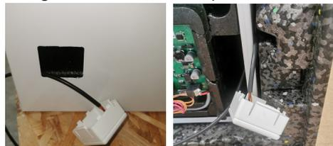
4. Per il montaggio a parete o a soffitto, agganciare il modulo radio nell'apertura dell'alloggiamento in lamiera premendo leggermente i collegamenti a scatto. In caso di installazione in una scatola di montaggio, posizionare il modulo radio nell'incavo della scatola di montaggio.
