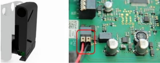
2. Rompa la superficie preperforada y sujeta por dos barras de la pared lateral del soporte de pared. La abertura sirve para montar el módulo inalámbrico.
