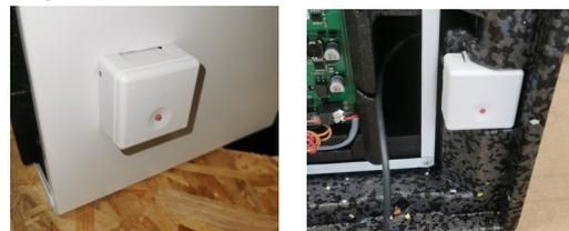
5. Introduzca la clavija de enchufe del cable de conexión en el casquillo de la pletina de control (v. Conexión eléctrica) y tienda el cable en la guía de cable prevista para ello. El resto del cable se guarda en el espacio entre la carcasa EPP y el panel.
