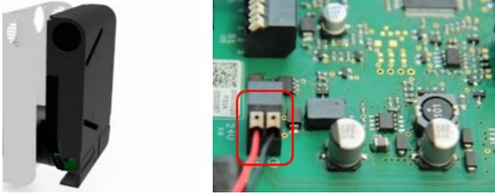
2. Brechen Sie die von zwei Stegen gehaltene, vorperforierte Fläche aus der Seitenwand der Wandhalterung aus. Die Durchbruchöffnung dient der Aufnahme des Funkmoduls.
