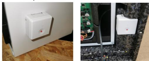
5. Zasuňte elektrickou zástrčku připojovacího kabelu do zásuvky desky plošných spojů řídicí jednotky (viz Elektrické připojení) a uložte kabel do určeného kabelového kanálu. Zbývající kabel je uschován v prostoru mezi EPP krytem a plechovým krytem.
