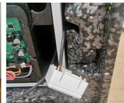
4. En cas de montage mural ou au plafond, clipsez le module radio dans l'ouverture du boîtier en appuyant légèrement sur les points d'encliquetage. Pour le montage dans un boîtier encastré, insérez le module radio dans l'ouverture du boîtier encastré.
