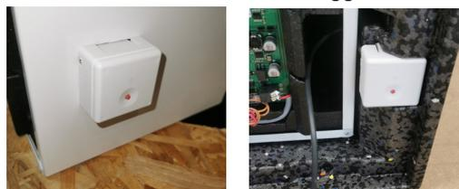
5. Inserire la spina del cavo di collegamento nella presa della scheda di controllo (vedere Allacciamento elettrico) e posare il cavo nell'apposita guida. Il cavo rimanente viene riposto nello spazio tra l'alloggiamento in PPE e l'alloggiamento in lamiera.
