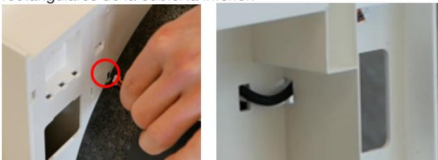
3. Presione el cable de conexión en la canaleta para cables de la carcasa EPP y ciérrela con la cinta adhesiva. Con unos alicates de boca plana corte la ranura para introducir el cable de conexión en la carcasa del módulo inalámbrico.
