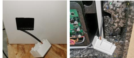
4. Klipsen Sie bei der Wand- oder Deckenmontage das Funkmodul unter leichtem Zusammendrücken der Rastverbindungen in die Durchbruchöffnung des Blechgehäuses. Bei der Montage in einem Einbaukasten, setzen Sie das Funkmodul in die Aussparung in dem Einbaukasten.
