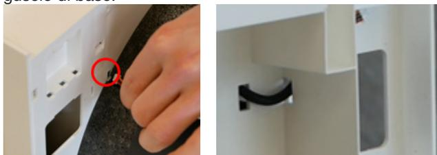
3. Premere il cavo di collegamento nella scanalatura dell'alloggiamento in EPP e richiuderla con nastro adesivo. Con una pinza a becchi piatti adatta, rompere l'incavo per l'inserimento del cavo di collegamento nell'alloggiamento del modulo radio.
