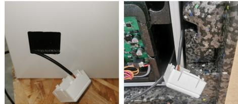
4. En el montaje en el techo y en la pared inserte el módulo inalámbrico apretando ligeramente las conexiones de encaje en la abertura del panel. En el montaje en una caja empotrada coloque el módulo inalámbrico en la ranura de la caja empotrada.
