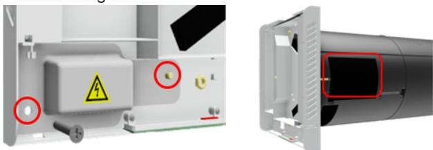
2. Inserire un'estremità del cavo di collegamento nella scheda di controllo (vedere Allacciamento elettrico) e far passare l'altra estremità attraverso le due aperture rettangolari del guscio di base.
