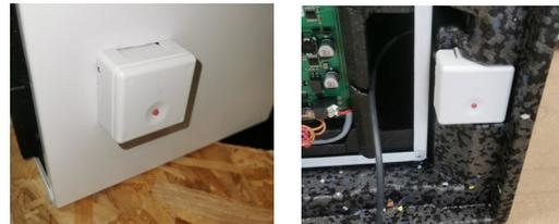
5. Stecken Sie den Stecker des Anschlusskabels in die Buchse der Steuerungsplatine (s. Elektrischer Anschluss) und verlegen Sie das Kabel in der dafür vorgesehenen Kabelführung. Das restliche Kabel wird in dem Raum zwischen dem EPP-Gehäuse und dem Blechgehäuse verwahrt.
