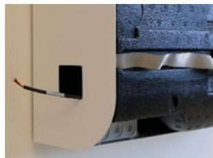
4. Enfichez le connecteur du câble de raccordement dans l'une des prises de la platine du module radio (voir Raccordement électrique). Une unité de commande externe en option est connectée au second connecteur. Clipsez le module radio dans l'ouverture pratiquée dans le support mural en appuyant légèrement sur les points d'encliquetage et en les orientant à la verticale.
