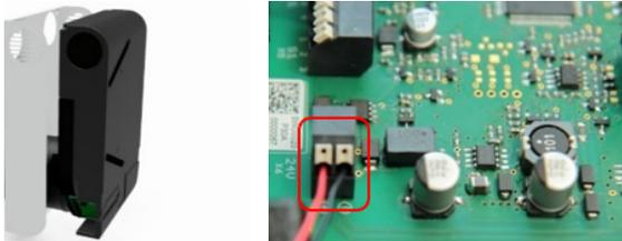
2. Spezzare la superficie preforata, sostenuta da due astine, dalla parete laterale del supporto a parete. L'apertura serve ad alloggiare il modulo radio.
