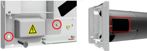
2. Introduzca la clavija de enchufe de uno de los extremos del cable de conexión en la pletina de control (v. Conexión eléctrica) y guíe el otro extremo a través de los dos orificios rectangulares de la cubierta inferior.
