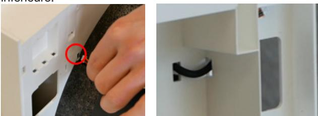
3. Introduire le câble de raccordement dans la rainure de câbles du boîtier en PPE et refermer la rainure avec le ruban adhésif. À l'aide d'une pince plate appropriée, percer l'ouverture destinée à l'introduction du câble de raccordement dans le boîtier du module radio.
