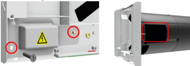
2. Brancher le connecteur d'une extrémité du câble de raccordement à la platine de commande (voir Raccordement électrique) et faire passer l'autre extrémité par les deux ouvertures rectangulaires de la coque inférieure.
