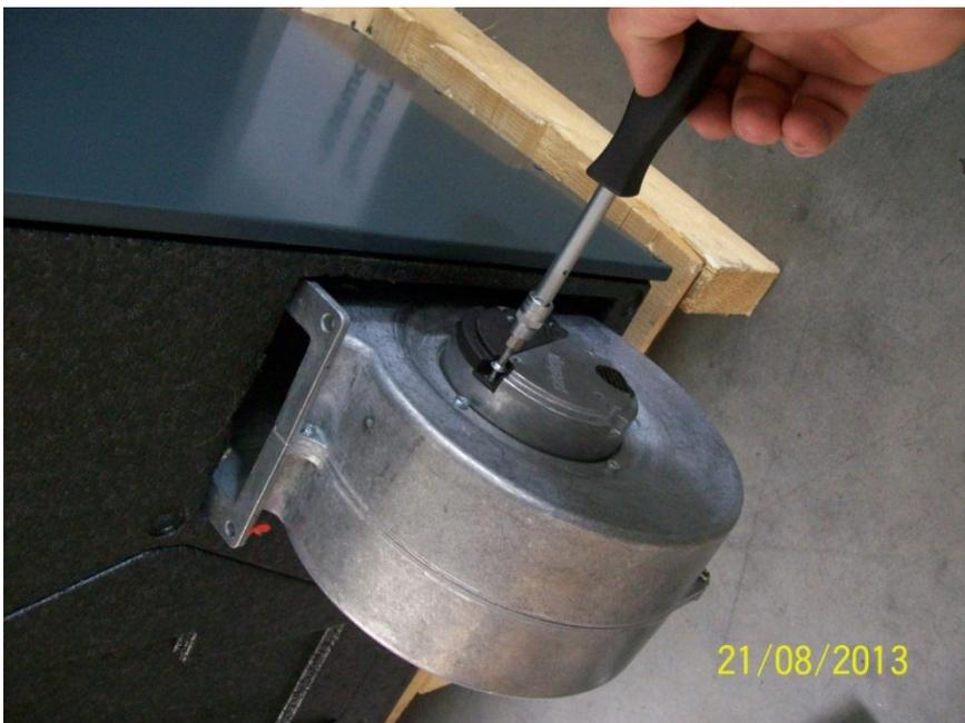
7. Setzen Sie den Ventilator in das Gehäuse des Lüftungsgerätes ein.
