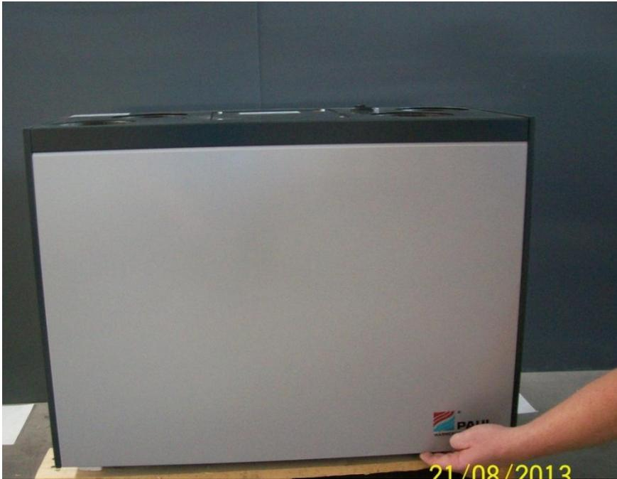
4. Hebeln Sie mit Hilfe einer Spachtel die EPP-Ventilatorabdeckung aus dem Gehäuse.
