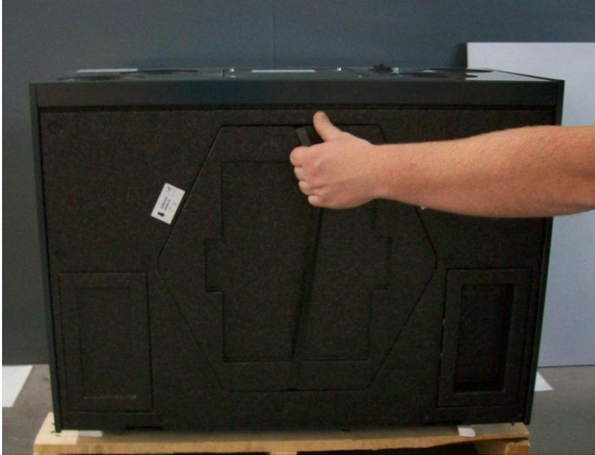
4. Ziehen Sie die Filter am Zugband fassend aus den Filterfächern.
