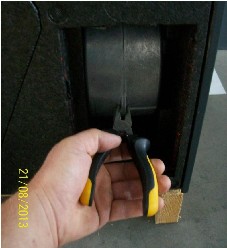
6. Öffnen Sie die 3 Torx-Schrauben und ziehen Sie den Ventilatorstecker ab.
