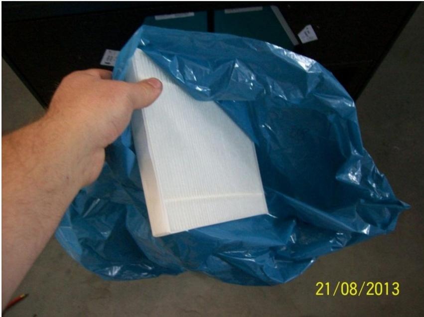
6. Die Filter sind auf dem Filterrahmen für die vorgeschriebene Filterdurchströmungsrichtung mit einem Pfeil gekennzeichnet. Setzen Sie die neuen Filter entsprechend der vorgegebenen Filterdurchströmungsrichtung ein.
