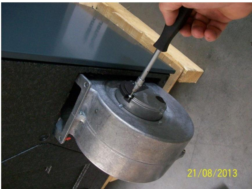
9. Schieben Sie den Lüfter komplett in das Gerät.
