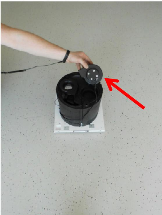
16. Setzen Sie den neuen Abluftventilator ein und fixieren Sie das Ventilatoranschlusskabel mit Klebeband wieder im EPP-Gehäuse.
