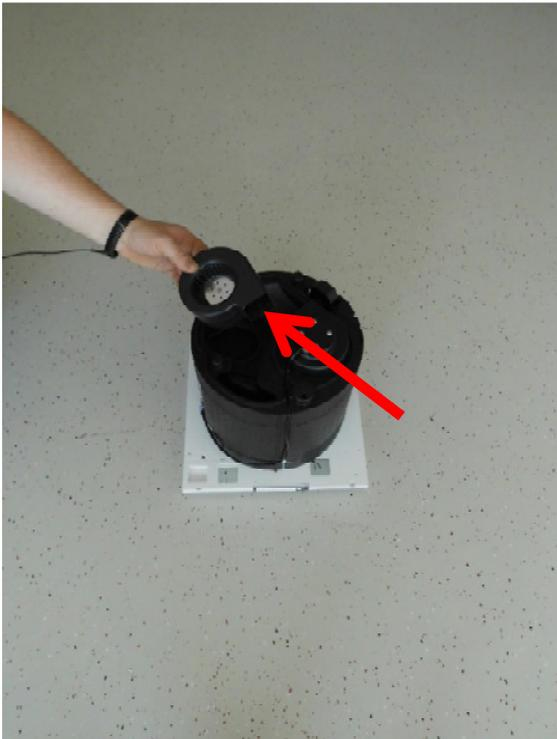
15. Führen Sie das Anschlusskabel des neuen Ventilators durch das EPP-Gehäuse und setzen Sie den neuen Zuluftventilator ein.
