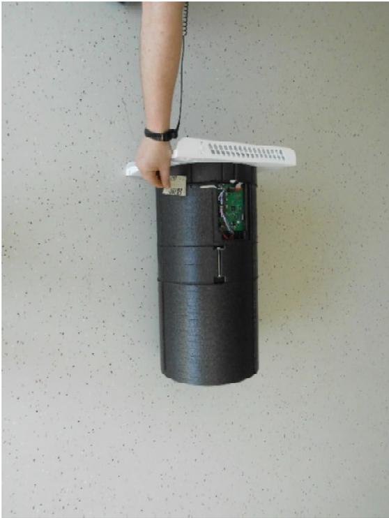
13. Lösen Sie die beidseitigen Schraubverbindungen des EPP-Gehäuses und entnehmen Sie die Schrauben.
