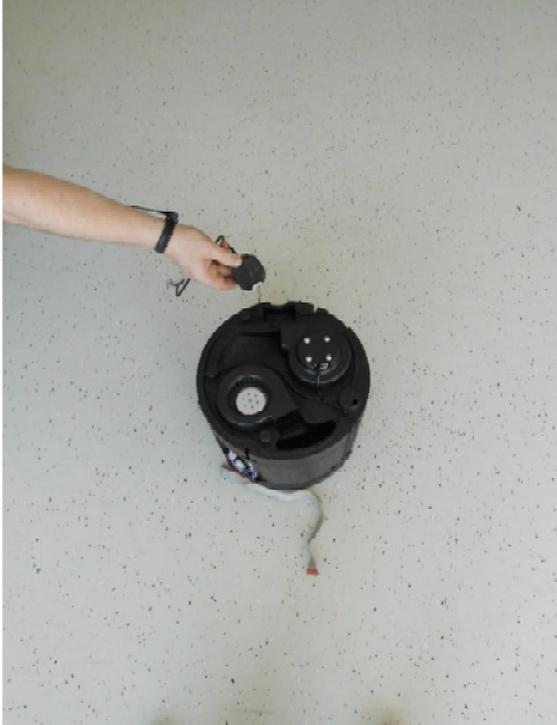
17. Setzen Sie das neue Netzteil in das EPP- Gehäuse ein.
