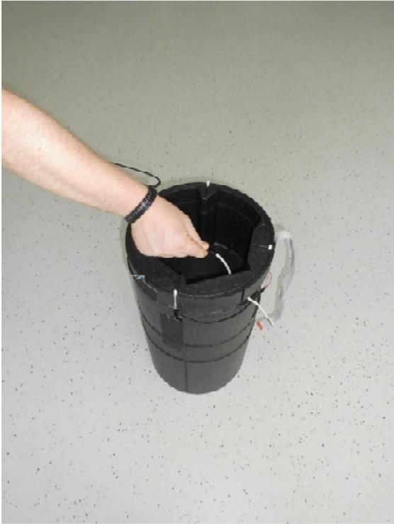
17. Setzen Sie den neuen Temperatursensor in das EPP- Gehäuse ein, achten Sie darauf, diesen in der vorgesehenen EPP Führung zu fixieren.
