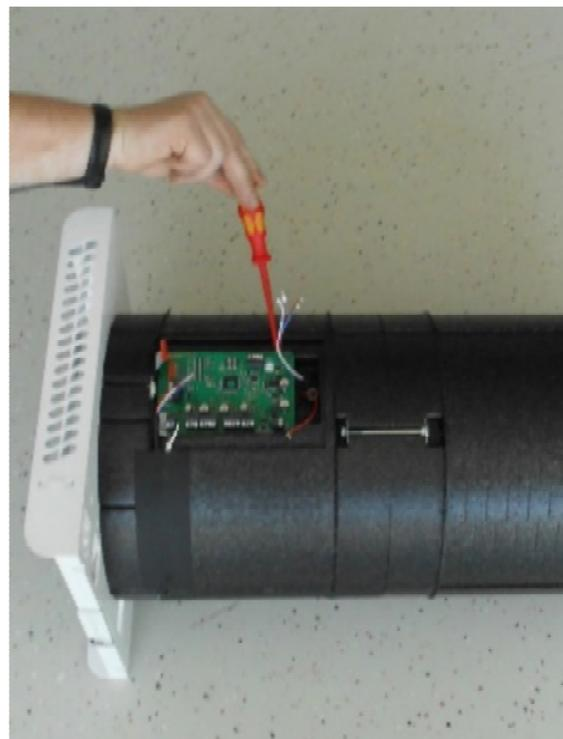
12. Der Austausch der Steuerungsplatine kann nun erfolgen. Verbinden Sie danach alle Kabel laut Schaltplan wieder mit der Platine (Netzverbindung zum Schluss).
