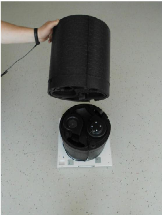
14. Ziehen Sie den Zuluftventilator aus dem EPP-Gehäuse, führen Sie dabei das Lüfter Anschlusskabel vorsichtig nach und ziehen es ebenfalls aus dem EPP-Gehäuse.
