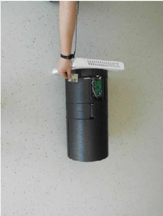
16. Ziehen Sie den Temperatursensor aus dem EPP-Gehäuse.
