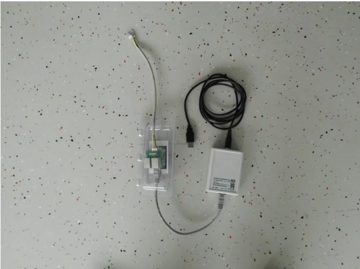
13. Schließen Sie die Programmierschnittstelle an das Gerät an. Ziehen Sie dazu das Programmierkabel durch die Öffnung in der Unterschale Innenblende.
