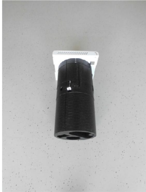
13. Ziehen Sie die EPP-Rohrverlängerung vom Grundgerät.
