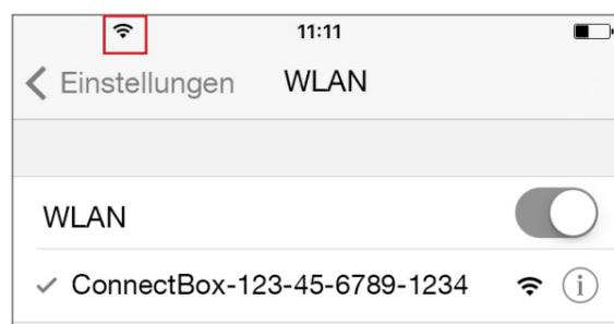
Falls das WLAN Symbol am Montageort der Endgeräte nicht mehr angezeigt wird sollte der Standort der Connect-Box überprüft werden. Ist kein besserer Standort möglich, siehe Seite 2: **ERWEITERUNG DER FUNKREICHWEITE**
