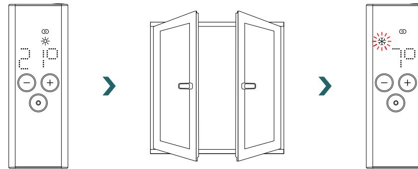
Se l'IHC rileva che la finestra o la porta sono state chiuse, il sistema ritorna automaticamente all'ultima modalità di riscaldamento selezionata.
