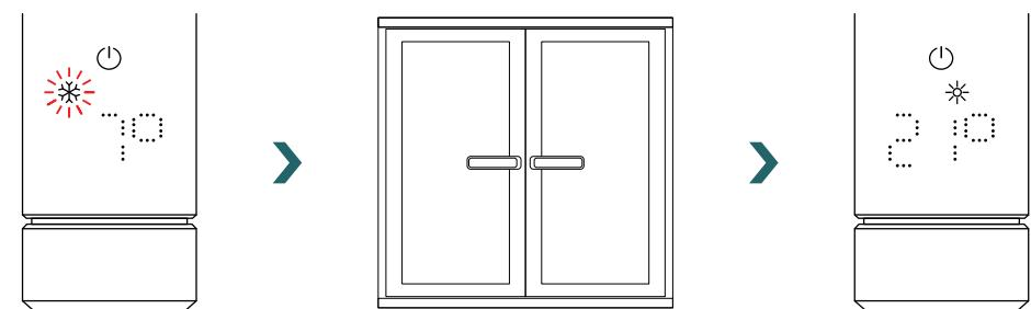
Funkcja wykrywania otwartego okna jest domyślnie włączona, ale można ją wyłączyć w ustawieniach aplikacji Zehnder Connect.
