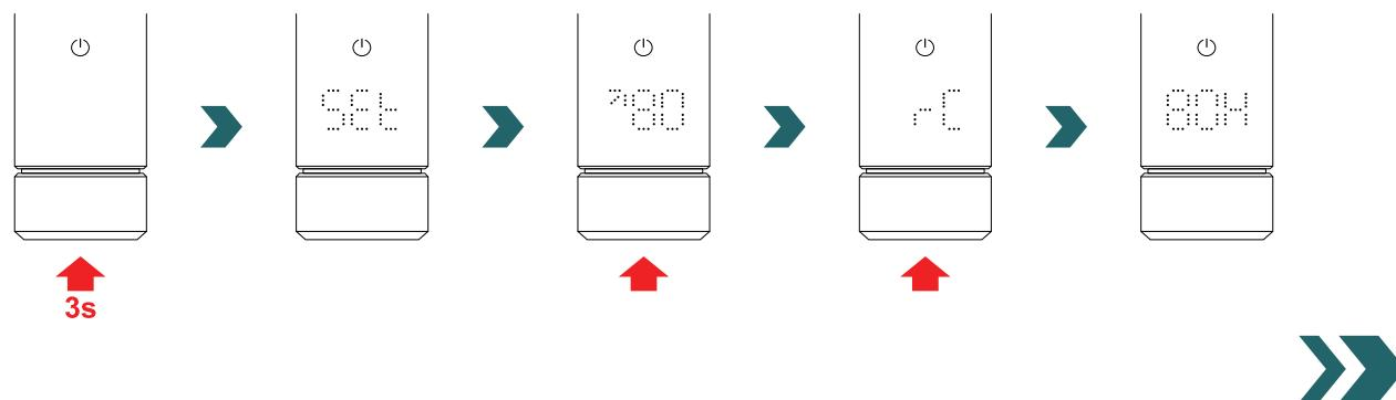
Mentre è visualizzato "BOX" ruotare la manopola per avviare il processo di accoppiamento. Una volta completato correttamente l'accoppiamento al Connection Hub, il display dell'IHC visualizza "ok" per 5 secondi e l'icona dello stato di collegamento si illumina.
