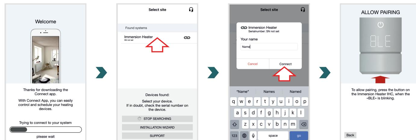
Kiedy na wyświetlaczu IHC zamiga napis „BLE”, nacisnąć pokrętło, aby potwierdzić sparowanie z aplikacją Connect. Udane połączenie jest sygnalizowane przez IHC wyświetlaniem komunikatu „Ok”.
