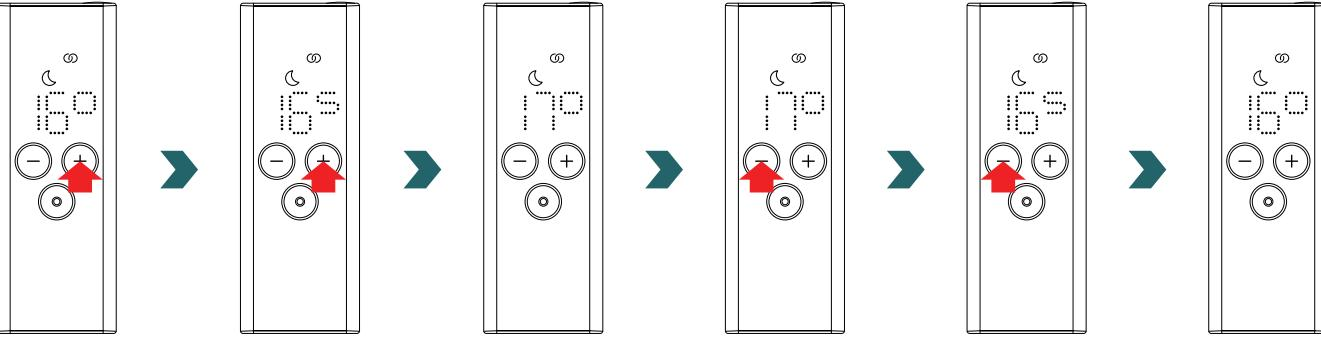
Veuillez noter que la température intérieure en mode éco ne peut pas être supérieure à la température intérieure réglée en mode confort -1 °C.
