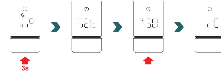
Gdy wyświetlany jest napis „rC”, obrócić pokrętło. Proces parowania trwa 60 sekund; w tym czasie należy nacisnąć dowolny przycisk na pilocie RCE.
