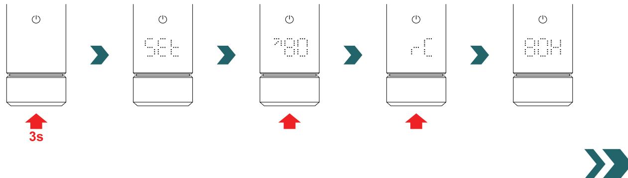
Wanneer 'BOX' wordt weergeven, verdraait u de draaiknop om het koppelingsproces te starten. Is de koppeling met de Connection Hub geslaagd, dan verschijnt gedurende 5 s 'ok' op het IHC-display en het verbindingssstatuspictogram gaat branden.
