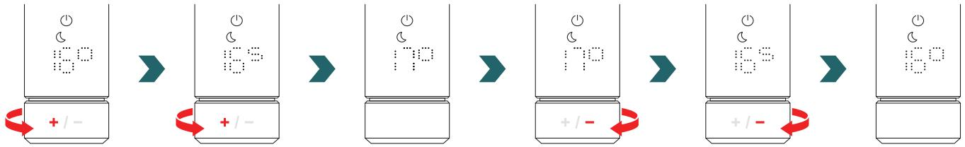
Veuillez noter que la température intérieure en mode éco ne peut pas être supérieure à la température intérieure réglée en mode confort de -1 °C.
