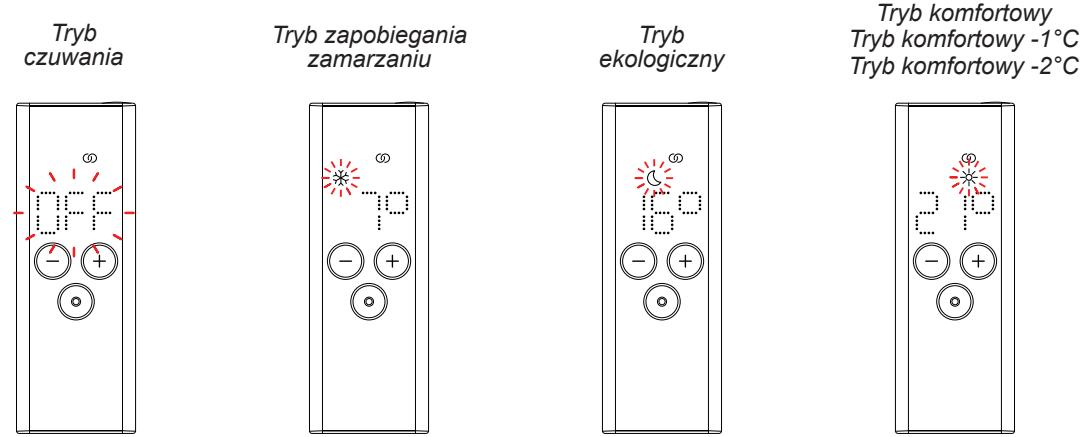
Gdy aktywne jest sterowanie przewodem sterującym, nadal można lokalnie zmienić tryb ogrzewania (naciskając przycisk trybu lub przycisk czuwania) na „niższy” niż aktualnie stosowany tryb przewodu sterującego.
