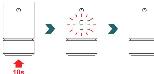
**i** Tras un reinicio se restablecen a los valores predeterminados todos los ajustes (p. ej., límite de temperatura superficial, temperaturas interiores deseadas para modo Confort y Eco, etc.).
