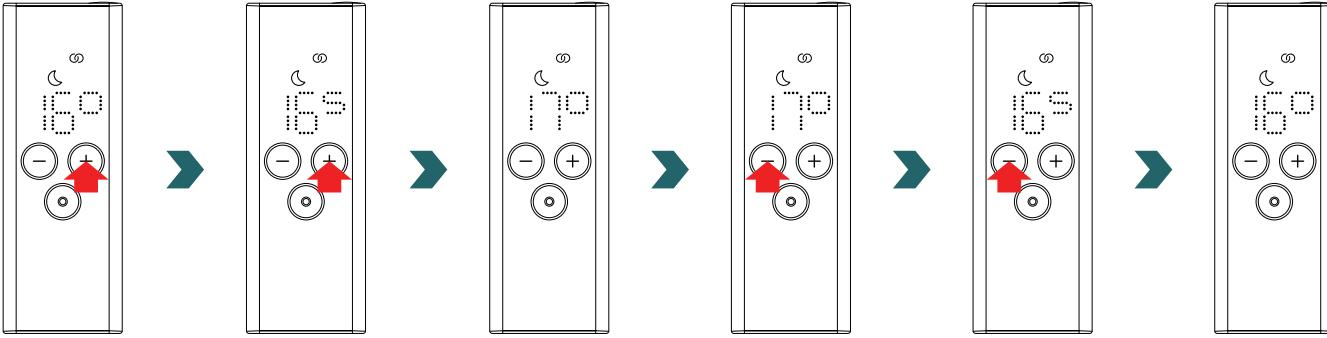
Denk eraan dat de ruimtetemperatuur in de ecomodus niet hoger kan zijn dan de ingestelde ruimtetemperatuur in de comfortmodus -1 °C.
