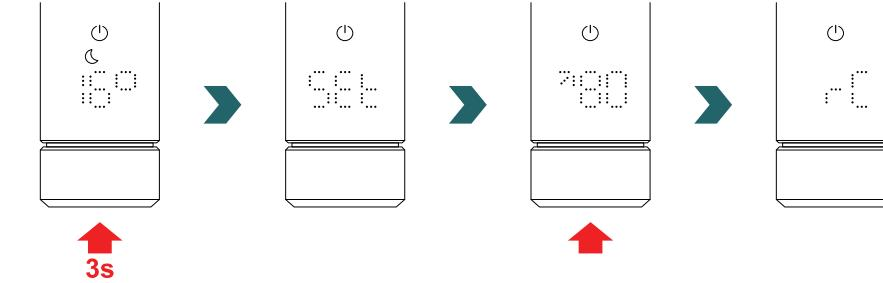
Wanneer 'rC' verschijnt, verdraait u de draaiknop. Het koppelingsproces start gedurende 60 s; in die tijd kunt u op elke knop op de RCE drukken.
