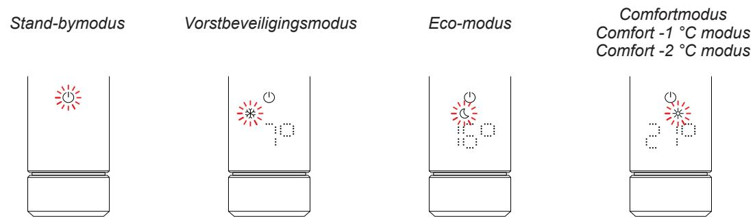
De IHC kan worden ingesteld op de stand-bymodus, vorstbeveiligingsmodus of ecomodus, of in de comfortmodus blijven met een 1 °C of 2 °C lagere temperatuur.
