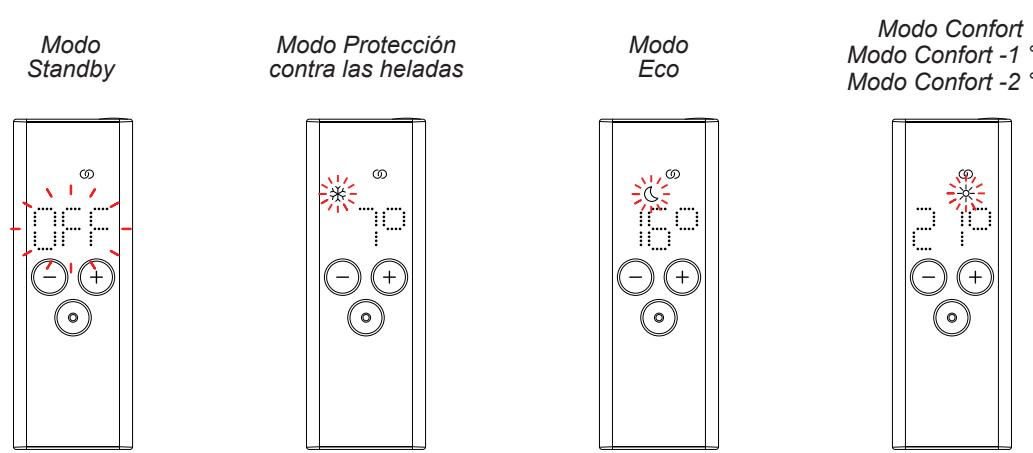
**Mientras está activo el control del cable piloto, todavía se puede cambiar el modo de calefacción (pulsando la tecla de modo o la tecla de standby) a un modo de calefacción "más bajo" que el modo de cable piloto aplicado en ese momento.**
