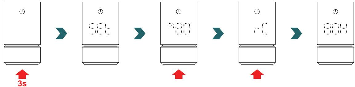
Wanneer 'BOX' wordt weergeven, verdraait u de draaiknop om het koppelingsproces te starten.
