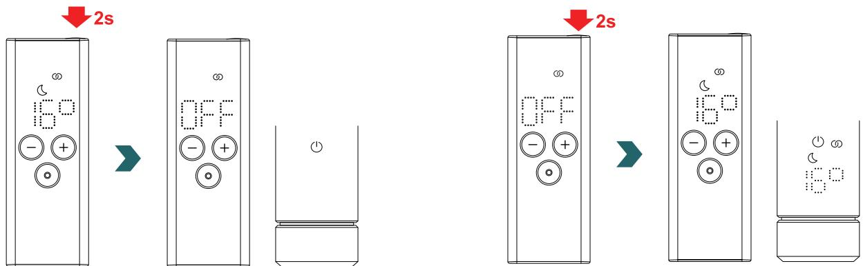
En el modo Standby están desactivadas todas las funciones de calefacción. Se emiten dos pitidos para indicar acústicamente que se ha seleccionado el modo Standby en el IHC.
