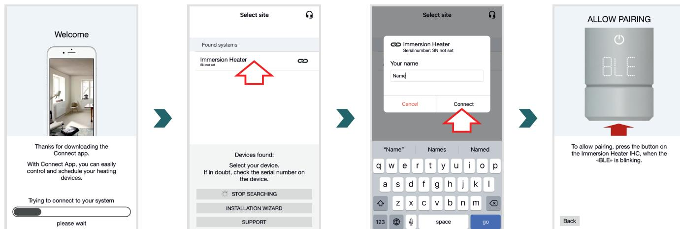
Lorsque « BLE » clignote sur l'écran de l'IHC, appuyez sur le bouton rotatif pour confirmer l'appairage avec l'application Acova Connect. Une fois la connexion établie, l'IHC affiche « Ok ».
