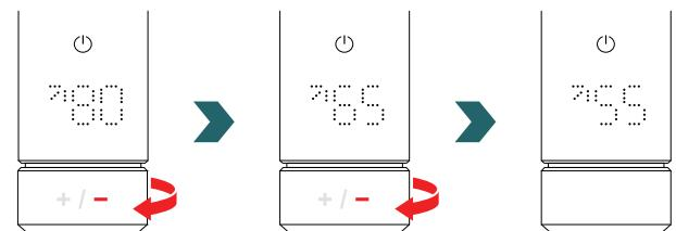
De maximale oppervlaktetemperatuur kan worden ingesteld op 45 °C / 55 °C / 65 °C of 80 °C.
