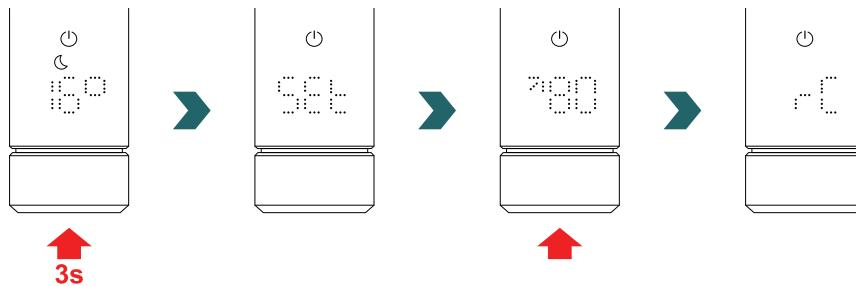
Wanneer 'rC' wordt weergegeven, verdraait u de draaiknop om het koppelingsproces te starten. Ga dan door met de 2e IHC.
