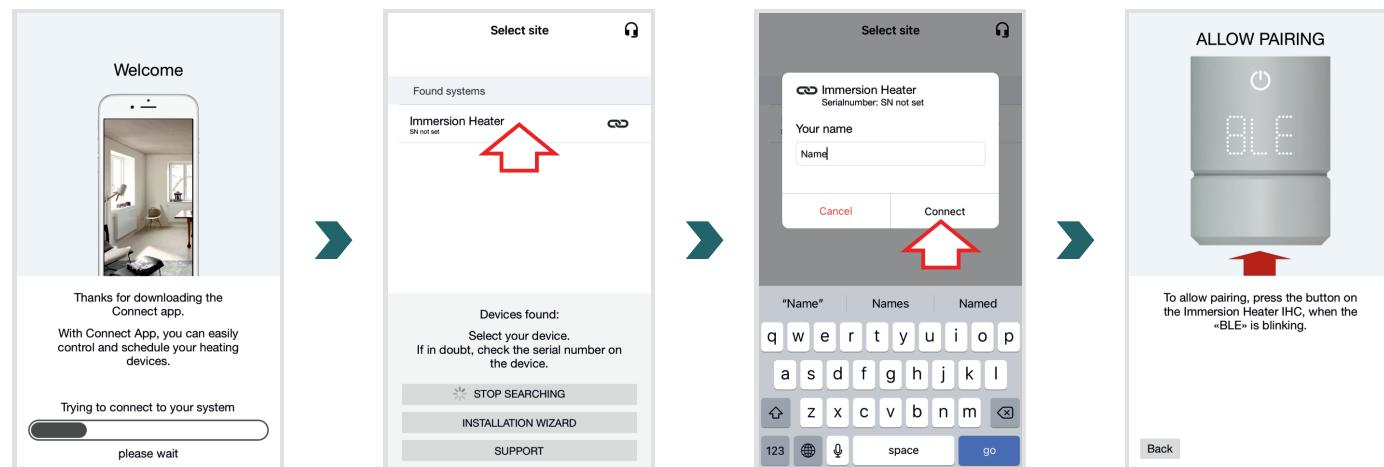
Quando sul display dell'IHC lampeggia "BLE", premere la manopola per confermare l'accoppiamento all'app Connect. Una volta stabilito correttamente il collegamento, il display dell'IHC visualizza "Ok".
