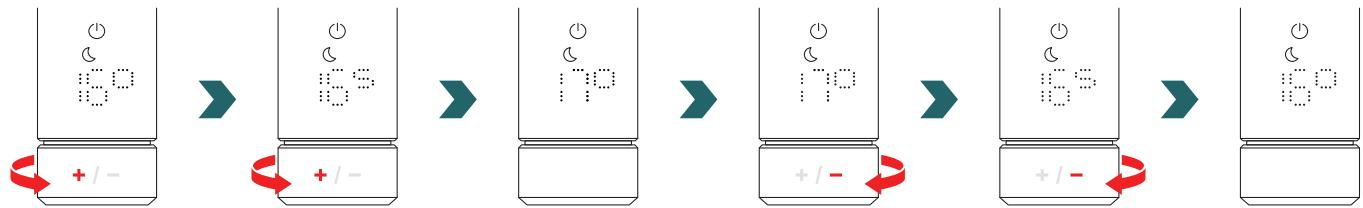
Denk eraan dat de ruimtetemperatuur in de ecomodus niet hoger kan zijn dan de ingestelde ruimtetemperatuur in de comfortmodus -1 °C.
