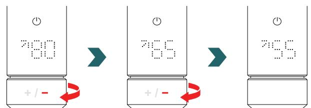
La limitation de la température de surface peut être réglée sur 45 °C / 55 °C / 65 °C ou 80 °C.
