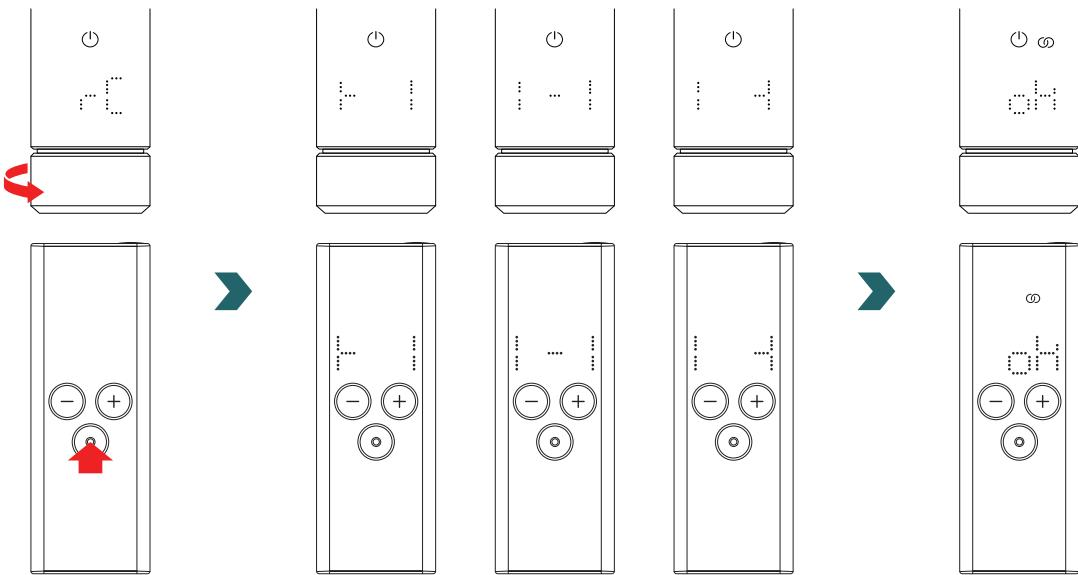
Wanneer 'rC' verschijnt, verdraait u de draaiknop. Het koppelingsproces start gedurende 60 s; in die tijd kunt u op elke knop op de RCE drukken.
