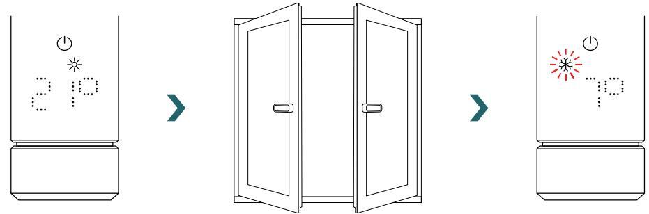
Si l'IHC détecte que la fenêtre ou la porte a été fermée, le système repasse automatiquement au dernier mode chauffage sélectionné. Il est également possible d'arrêter manuellement un mode fenêtre ouverte actif en appuyant sur le bouton rotatif.
