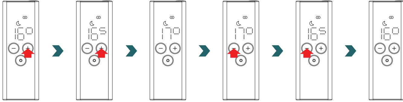
Należy pamiętać, że temperatura w pomieszczeniu w trybie ekologicznym nie może być wyższa niż ustalona temperatura w pomieszczeniu w trybie komfortowym -1°C.
