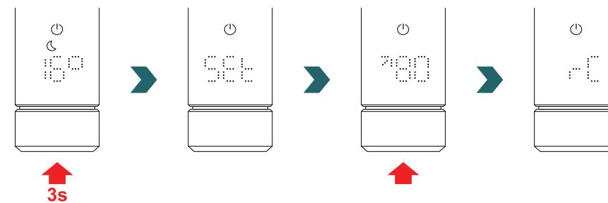
Mentre è visualizzato "rC" ruotare la manopola per avviare il processo di accoppiamento. Poi passare al 2° IHC.
