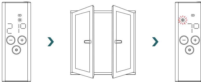
Si l'IHC détecte que la fenêtre ou la porte a été fermée, le système repasse automatiquement au dernier mode chauffage sélectionné. Il est également possible d'arrêter manuellement un mode fenêtre ouverte actif en appuyant sur le bouton mode de la RCE.
