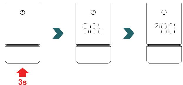
De maximale oppervlaktetemperatuur kan door verdraaien van de draaiknop worden aangepast.
