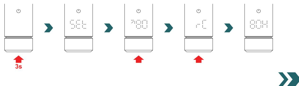
Lorsque « BOX » s'affiche, tournez le bouton rotatif pour lancer le processus d'appairage. Une fois l'appairage réussi avec la connect box, l'IHC affiche « ok » pendant 5 s et l'icône d'état de connexion s'allume.
