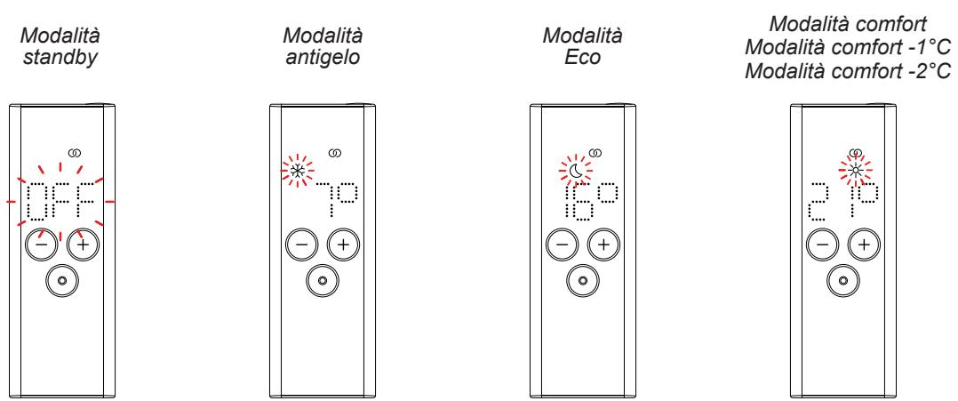
**Quando il controllo con filo pilota è attivo, è ancora possibile modificare la modalità di riscaldamento (premendo il pulsante delle modalità o il pulsante di standby) portandola a una modalità "inferiore" rispetto a quella filo pilota applicata in quel momento.**
