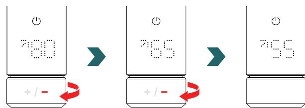
Il limite della temperatura superficiale può essere impostato a 45 °C / 55 °C / 65 °C o 80 °C.
