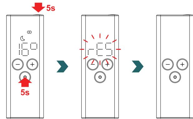
**i** Tras un reinicio todos los ajustes se restablecen a los valores predeterminados y se pierde la conexión con el IHC.
