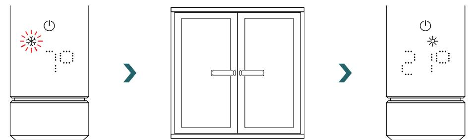
**La función de detección de ventana abierta está habilitada de forma predeterminada, pero puede desactivarse en los ajustes de la aplicación Connect de Zehnder.**
