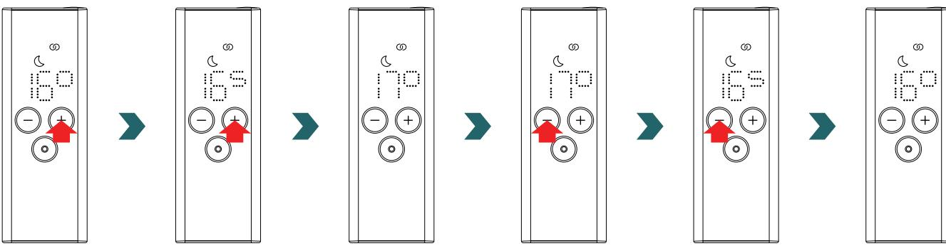
Tenga en cuenta que la temperatura interior del modo Eco no puede ser mayor que la temperatura interior ajustada del modo Confort -1 °C.
