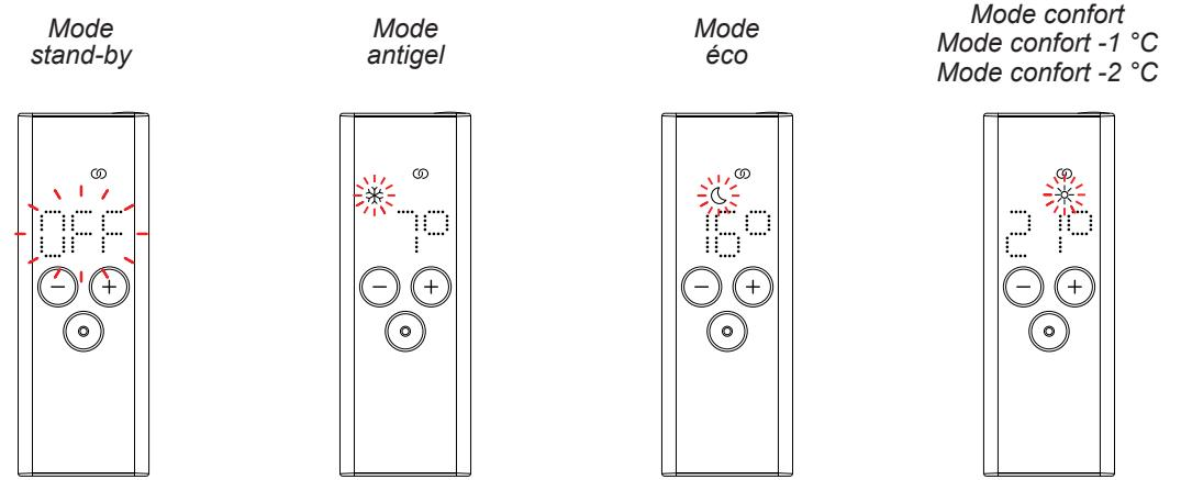
**Lorsque la commande par fil pilote est active, il est toujours possible de changer le mode de chauffage (en appuyant sur le bouton mode ou le bouton stand-by) et de sélectionner un mode de chauffage « inférieur » au mode de fil pilote actuellement appliqué.**
