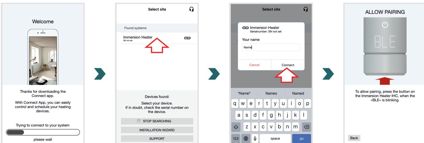
Wanneer op het IHC-display 'BLE' knippert, drukt u op de draaiknop om de koppeling met de Connect app te bevestigen. Een succesvolle verbinding is herkenbaar aan de melding 'Ok.' op het IHC-display.
