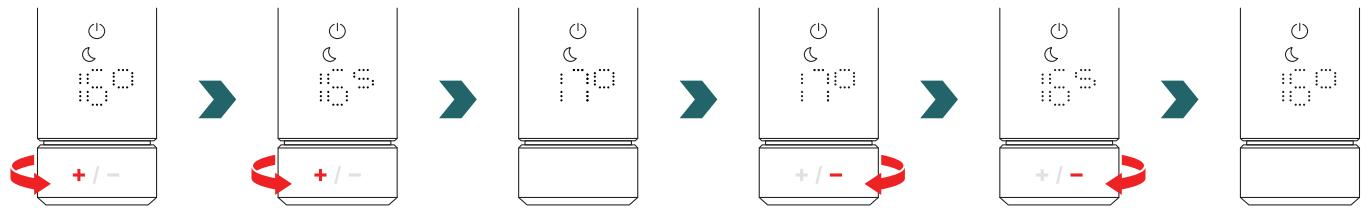
Należy pamiętać, że temperatura w pomieszczeniu w trybie ekologicznym nie może być wyższa niż ustalona temperatura w pomieszczeniu w trybie komfortowym -1°C.
