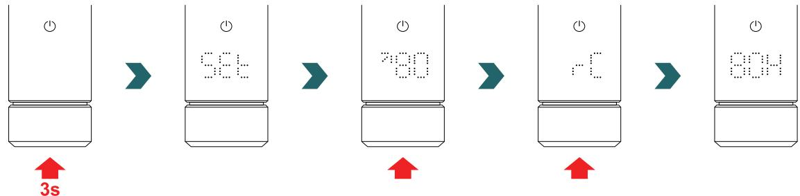
Gdy wyświetlany jest napis „BOX”, obrócić pokrętło, aby rozpoczęć proces parowania.
