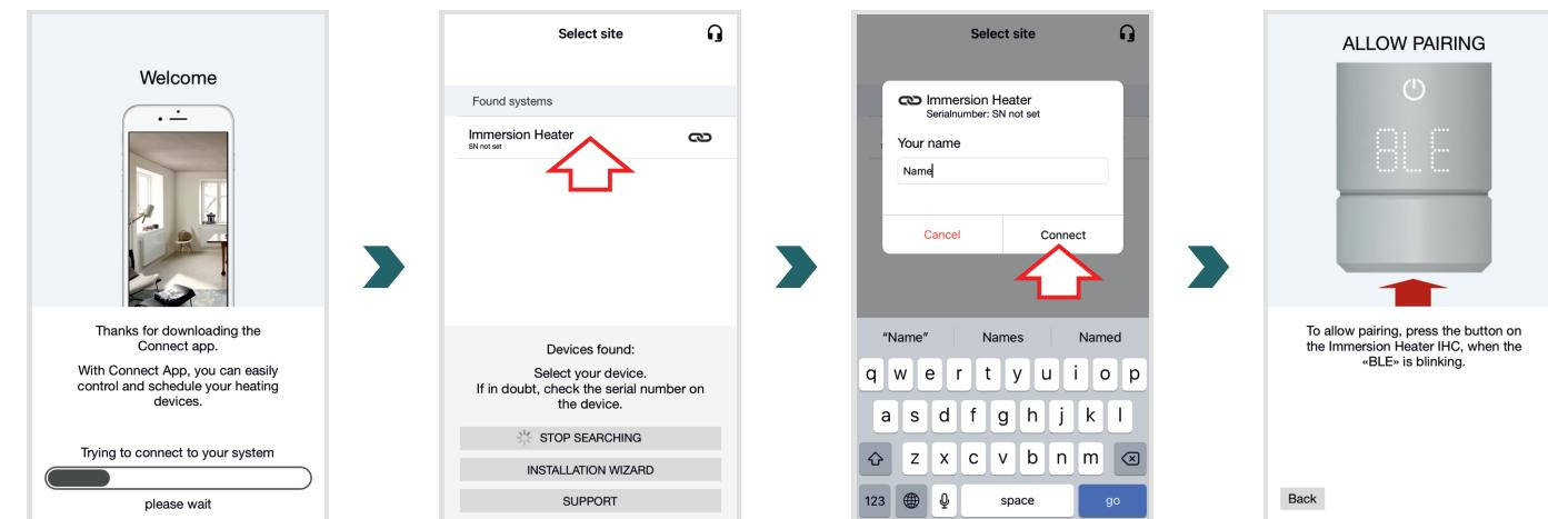
Cuando la pantalla de IHC destella “BLE”, pulsar el botón giratorio para confirmar el emparejamiento con la aplicación Connect. Si la conexión es correcta, en la pantalla del IHC se muestra “Ok.”.
