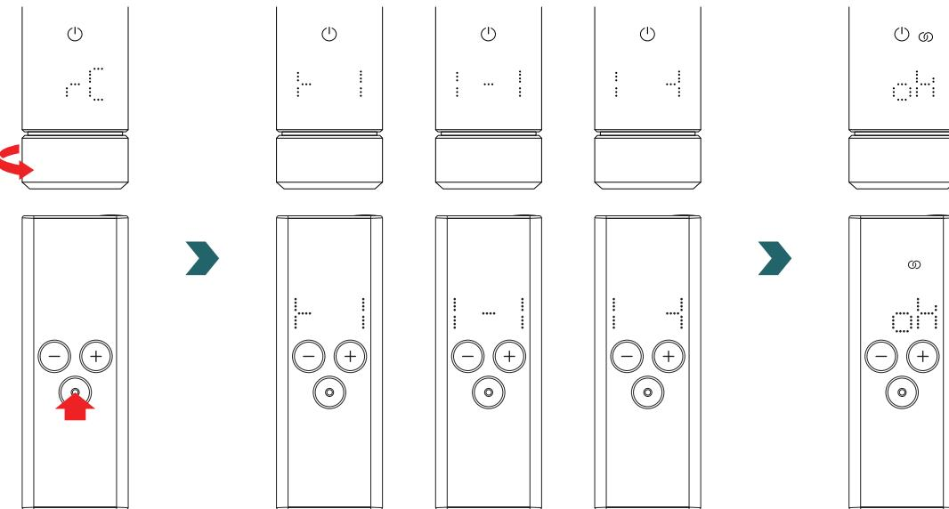
Gdy wyświetlany jest napis „rC”, obrócić pokrętło. Proces parowania trwa 60 sekund; w tym czasie należy naciąć dowolny przycisk na pilocie RCE.
