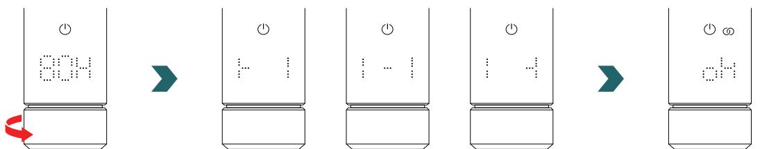
**i** Po sparowaniu IHC z modułem Connect-Box nie jest już możliwe połączenie IHC z pilotem RCE lub aplikacją Connect przez Bluetooth. Aby zmienić ustawienia połączenia, należy najpierw wykonać reset, jak opisano w punkcie 2.7.
