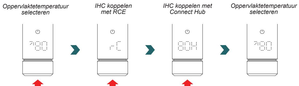
Het menu Instellingen kan worden gesloten door de draaiknop 3 s ingedrukt te houden of door 10 s te wachten zonder een handeling uit te voeren.
