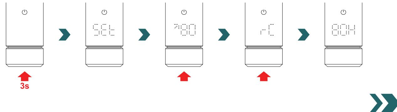
Gdy wyświetlany jest napis „BOX”, obrócić pokrętło, aby rozpocząć proces parowania. Po udanym sparowaniu z modułem Connect-Box na grzałce IHC przez 5 sekund wyświetlany jest napis „ok” i zaświeci się ikona statusu połączenia.
