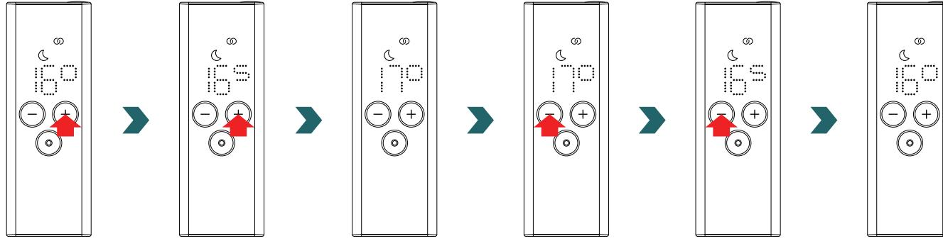
Si noti che la temperatura ambiente della modalità Eco non può essere superiore alla temperatura ambiente della modalità Comfort impostata -1 °C.
