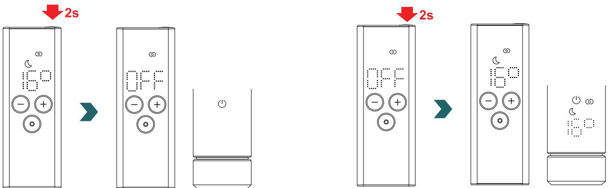
**i** En mode stand-by, toutes les fonctionnalités de chauffage sont désactivées. La sélection du mode stand-by est signalée acoustiquement par deux bips sur l'IHC.
