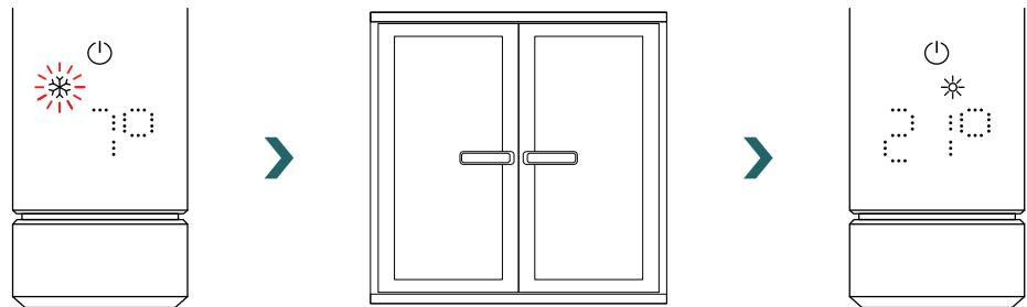
**La fonction de détection de fenêtre ouverte est activée par défaut, mais peut être désactivée dans les réglages de l'application Acova Connect.**
