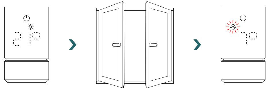
Se l'IHC rileva che la finestra o la porta sono state chiuse, il sistema ritorna automaticamente all'ultima modalità di riscaldamento selezionata.
