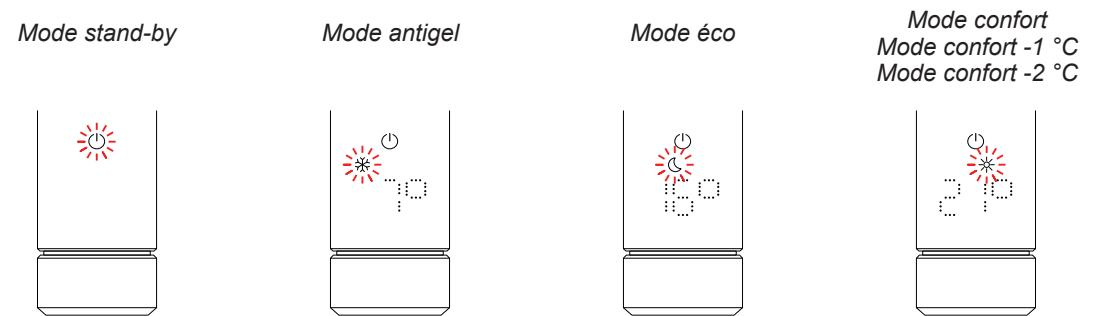
L'IHC peut être réglée en mode stand-by, en mode antigel ou en mode éco, ou bien rester en mode confort avec une température réduite de 1 °C ou 2 °C.
