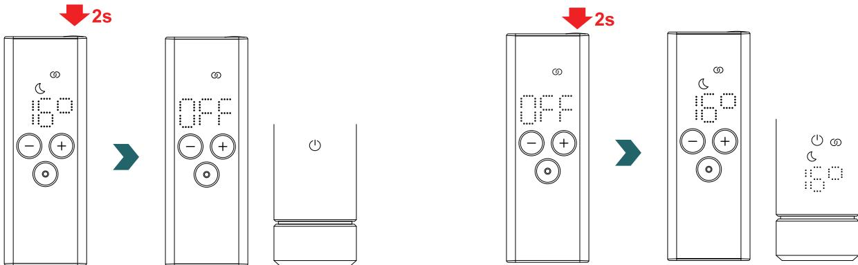
W trybie czuwania wszystkie funkcje ogrzewania są wyłączone. Wybór trybu czuwania jest sygnalizowany akustycznie dwoma sygnałami dźwiękowymi na grzałce IHC.
