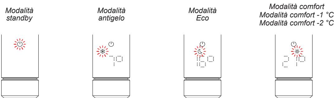
L'IHC può essere portato in modalità Standby, Antigelo o Eco, oppure rimanere in modalità Comfort con una temperatura ridotta di 1 °C o 2 °C.
