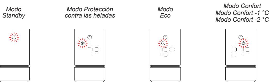
Se puede ajustar el IHC en modo Standby, modo Protección contra las heladas o modo Eco, o mantener en modo Confort con una temperatura reducida de 1 °C o 2 °C.
