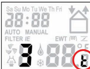
Nach Ablauf der eingestellten Zeitverzögerung schaltet das ComfoAir wieder in die vorherige Belüftungsstufe zurück.
