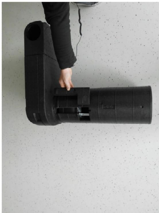
11. Lösen Sie die Fixierungsschraube des Abluftventilators.
