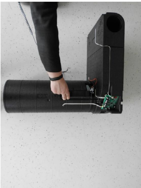
14. Legen Sie die Ventilator-Klappeneinheit auf das EPP Gehäuse, sodass die Kabel nicht aus dem Gehäuse entfernt werden müssen.
