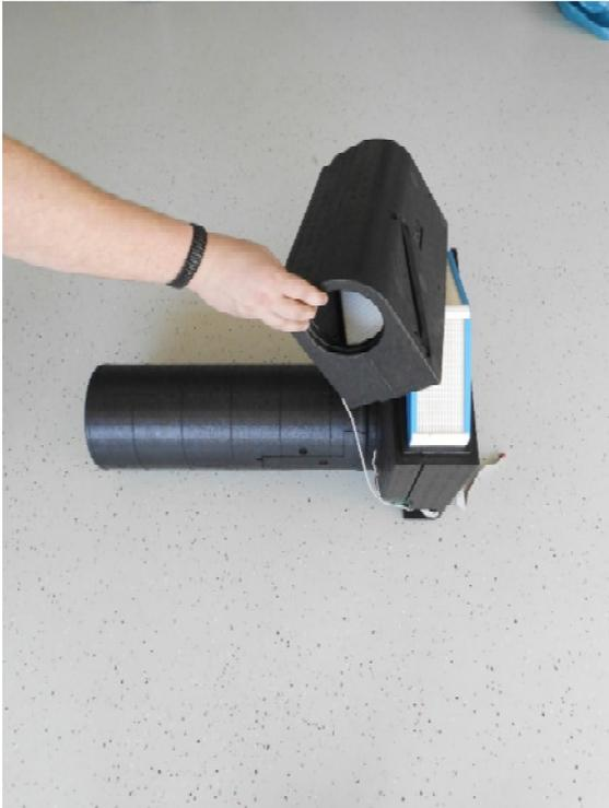
11. Ziehen sie den Sensor Vorsichtig aus der Halterung und trennen den Stecker des Sensorkabels. Ziehen Sie dabei **nicht(!)** am Kabel, sondern nur am Stecker!
