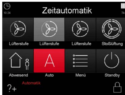
Abb. 8: Automatik-Modus Zeitautomatik mit aktiver Lüfterstufe LS2
