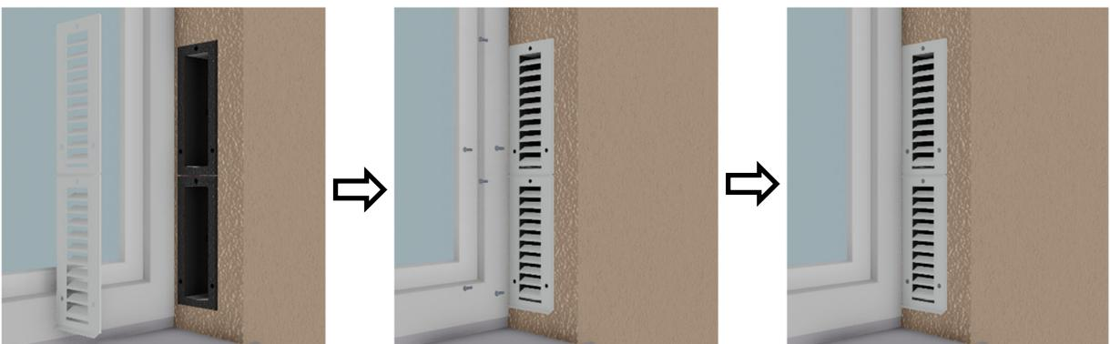
3. Die Position der in Bodenmitte des Kanal-Adapters (8) verlaufenden Kondensatrinne befindet sich minimal über der unteren Kante des Kondensatauslassschlitzes des Auslassgitters (10).
