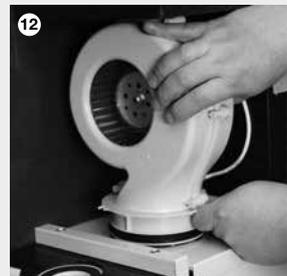
12 Drehen Sie den Lüfter um 45° und ziehen Sie diesen nach oben aus der Halterung.
