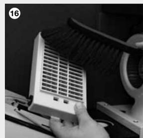
16 Bürsten oder Saugen Sie den Filter des Vorerwärmers ab. Fügen Sie anschliessend den Einsatz wieder ein und setzen Sie das Gerät in umgekehrter Reihenfolge wieder zusammen.
