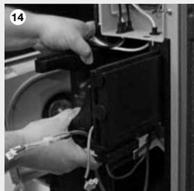
14 Stecken Sie die Verbindungsleitungen aus, entnehmen Sie das EPP Gehäuse und führen Sie dabei die Verbindungsleitungen nach.
