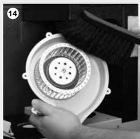
14 Bürsten Sie das Gehäuse und den Ventilator mit einer weichen Bürste ab. Anschliessend setzen Sie die Ventilatoren wieder ein.
