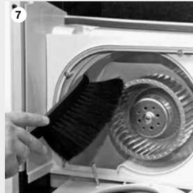
Bürsten Sie das Gehäuse und den Ventilator mit einer weichen Bürste ab. Anschliessend setzen Sie die Ventilatoren wieder ein.
