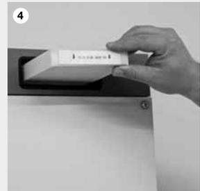
4 Überprüfen Sie die Filter auf Verunreinigungen und wechseln Sie die Filter bei Bedarf.
