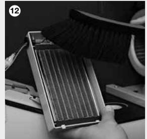
Bürsten oder Saugen Sie den Filter des Vorerwärmers ab. Fügen Sie anschliessend den Einsatz wieder ein und setzen Sie das Gerät in umgekehrter Reihenfolge wieder zusammen.
